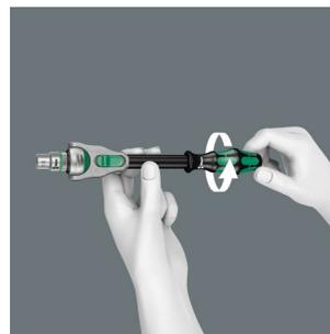
Die Zyklop Speed-Knarren sind echte Schnelldreher: Die Schwungmassen-Konstruktion sorgt für die Beschleunigung des Schraubprozesses. Der rotationssymmetrische Aufbau des Kraftform-Griffs und die Freilaufhülse unterstützen das rasante Zwirbeln. Insbesondere dann, wenn durch ein zu leichtgängiges Gewinde die Knarre noch nicht greift.
