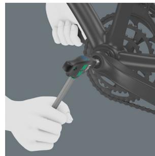
Der seitlich aus dem Griff austretende zusätzliche kurze Schenkel ermöglicht die Übertragung extrem hoher Drehmomente, indem der lange Schenkel als Hebel eingesetzt wird.
