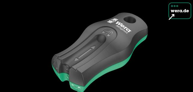
**Anwendung:** Einfach das Werkzeug an der positiven Seite des Wera Magnetisiergerätes entlang ziehen und schon hält das Werkzeug die Schraube sicher an der Klinge. Zum Entmagnetisieren das Werkzeug an der negativen Seite entlang führen.
