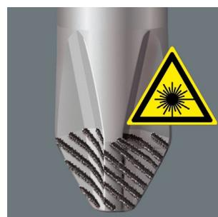
Mittels eng fokussiertem Laserlicht wird eine scharfkantige Oberflächenstruktur erzeugt. Die Laserbehandlung bewirkt eine Härte der Spure von bis zu 1000 HV 0,3. Wera Lasertip krallt sich im Schraubkopf fest und verhindert das Herausrutschen aus dem Schraubkopf.
