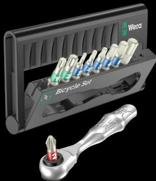
9 Bits; Edelstahl gegen Fremdrostgefahr, Torsionsform gegen frühzeitigen Verschleiß. 1 Wera Bit-Ratsche Zyklop Mini 1, gesenkgeschmiedete Vollstahlausführung; geeignet für die Aufnahme von Bits mit  $\frac{1}{4}$ "-Außensechskantantrieb nach DIN ISO 1173-C 6,3 und E 6,3 und Wera Anschluss-Reihen 1 und 4; über Adaptierung mit Wera Adapter 870/1 ist auch der Einsatz von  $\frac{1}{4}$ "-Nüssen möglich
