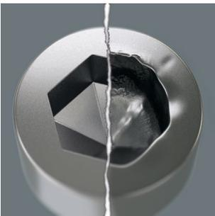
Innensechskantschrauben haben das Problem, schnell „rundgedreht“ zu werden. Grund ist die Einwirkung der scharfen Kante des Werkzeugs auf die Innenfläche des Schraubenkopfs. Der allmähliche Abnutzungsprozess führt schließlich zum „Runddrehen“. Wera Hex-Plus Werkzeuge haben
