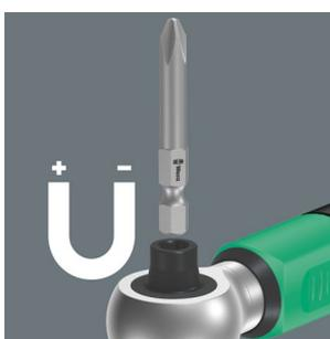
Der Safe-Torque Drehmomentschlüssel A 2 hat eine 1/4" Bitaufnahme mit starkem Dauermagneten und ist für Bits mit 1/4"-Außensechskantantrieb nach DIN ISO 1173-C 6,3 und E 6,3 und Wera Anschluss-Reihen 1 und 4 geeignet.
